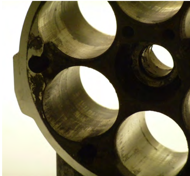
Resim 2 Silindirde sürtünme hasarı
