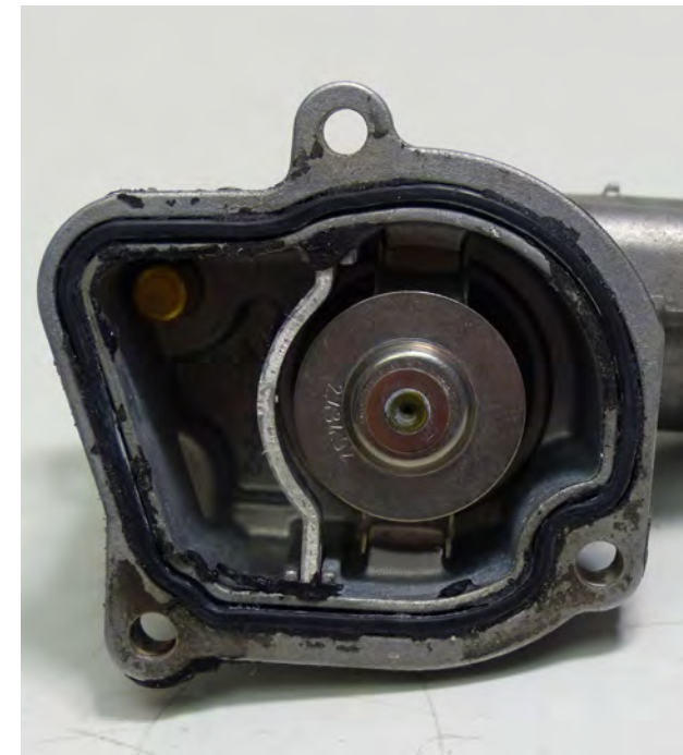
Resim 1 Termostat gövdesinde sızdırmazlık macunu
