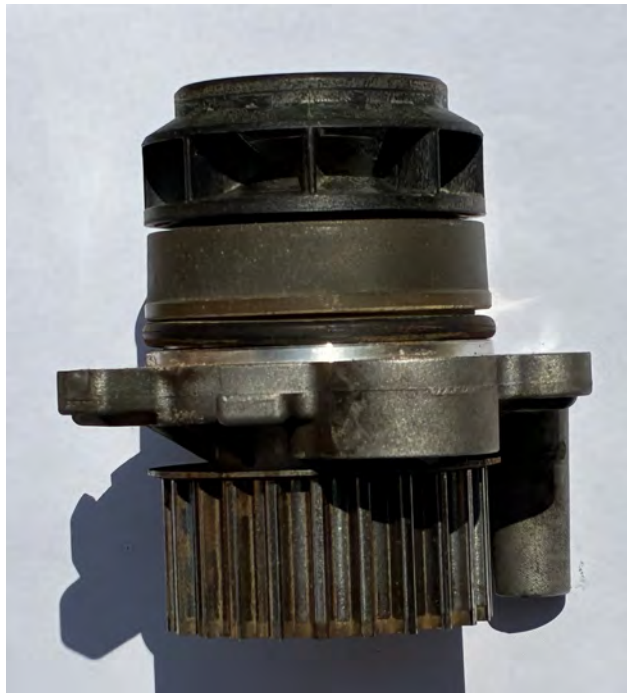
Resim 1 Plastik kanatlı çark milden ayrılmış
