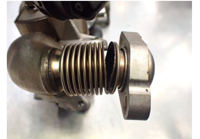
Resim 2 EGR soğutucusunun esnek borusu yırtılmış
