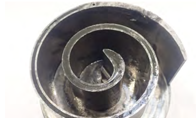
Resim 1 Scroll kompresörün salyangozu aşın derecede aşınmış
