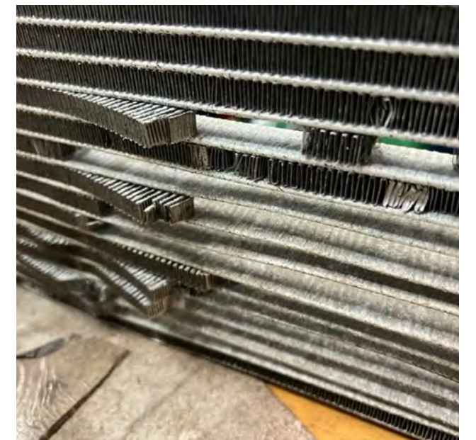
Resim 2 Korozyona uğramış soğutma kanatçıkları
