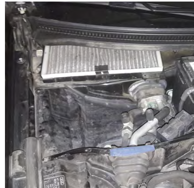
Resim 1 Aşırı kirlenmiş kabin filtresi
