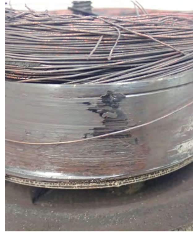
Resim 1 Bobin gövdesinde sürtünme izleri ve bobin yanmış
