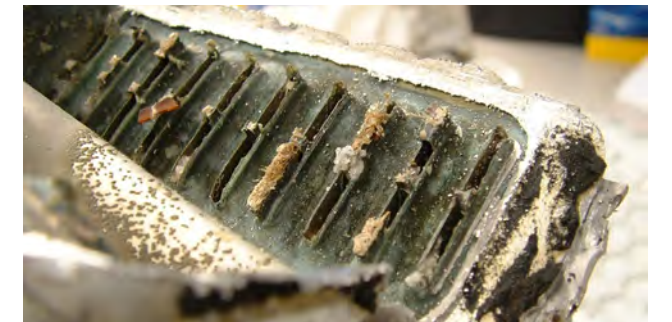
Resim 2 Sızdırmazlık maddesi nedeniyle radyatör tıkanmış
