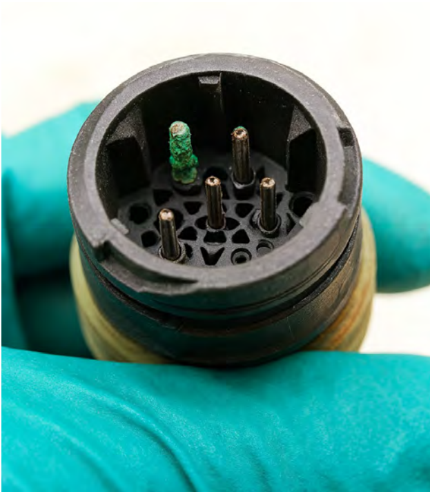
Resim 1 Fişte korozyon
