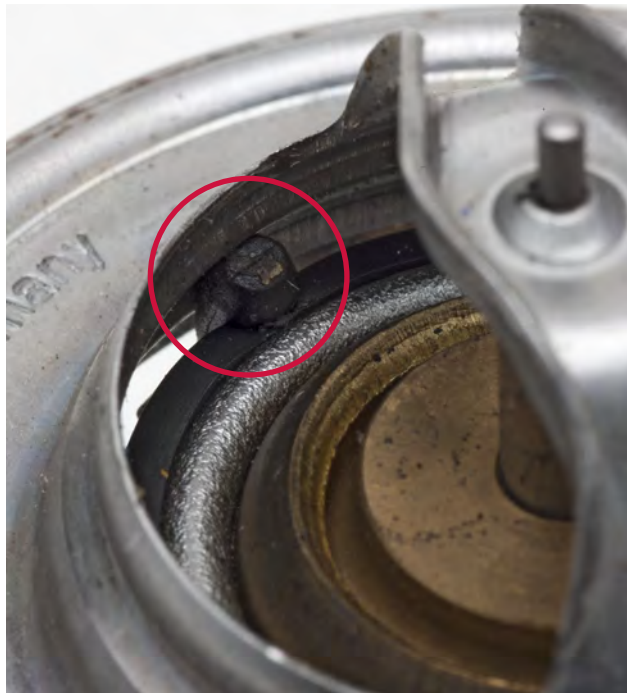
Resim 1 Yabancı cisim valfi tikiyor
