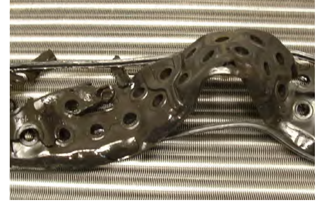
Resim 1 Soğutma sıvısı radyatöründen çıkan şişmiş conta
