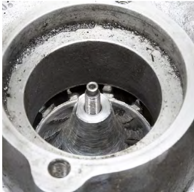
Resim 2 Turbo hasarından kaynaklanan talaşlar
