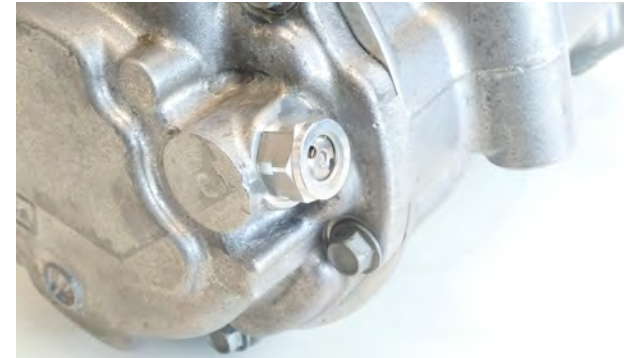
Resim 1 Aşırı basınç valfi tetiklenmiş
