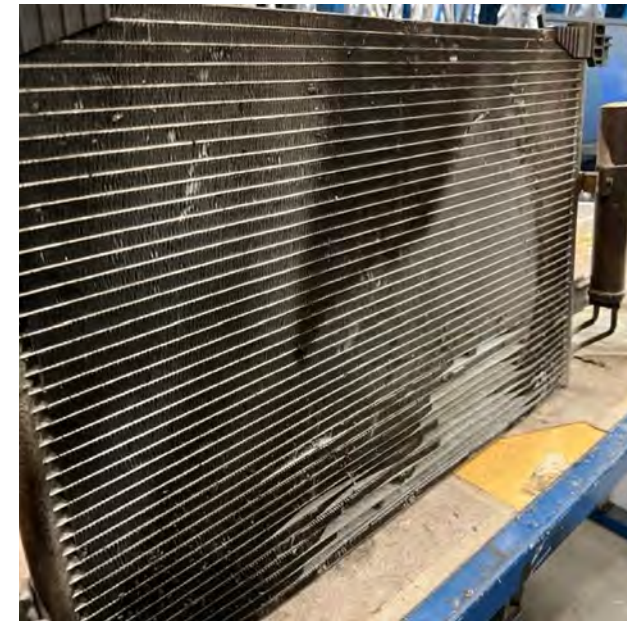
Resim 1 Kondansatörde korozyon
