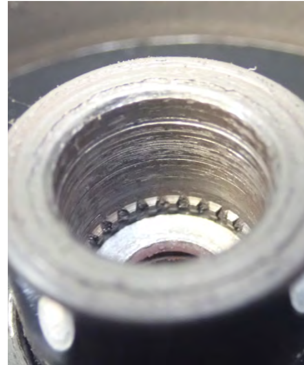
Resim 3 Dişler kırılmış
