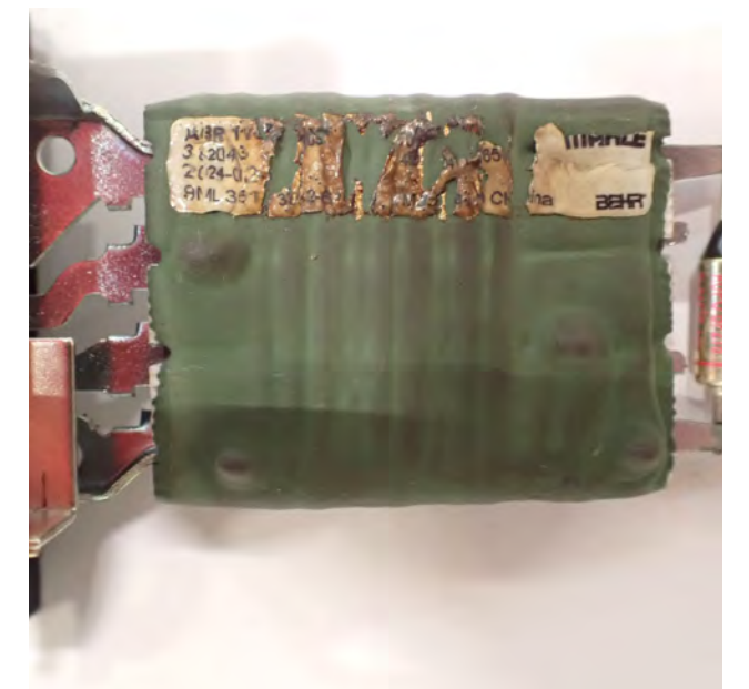
Resim 2 Fan regülatörü termik olarak aşırı yüklenmiş
