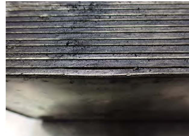
Resim 2 Sızdıran yağ radyatörü
