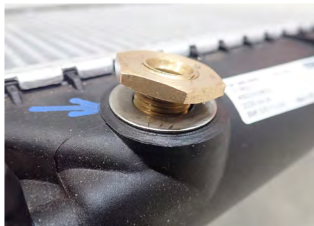
Resim 3 Şanzıman yağı hattının vidalı bağlantısı
