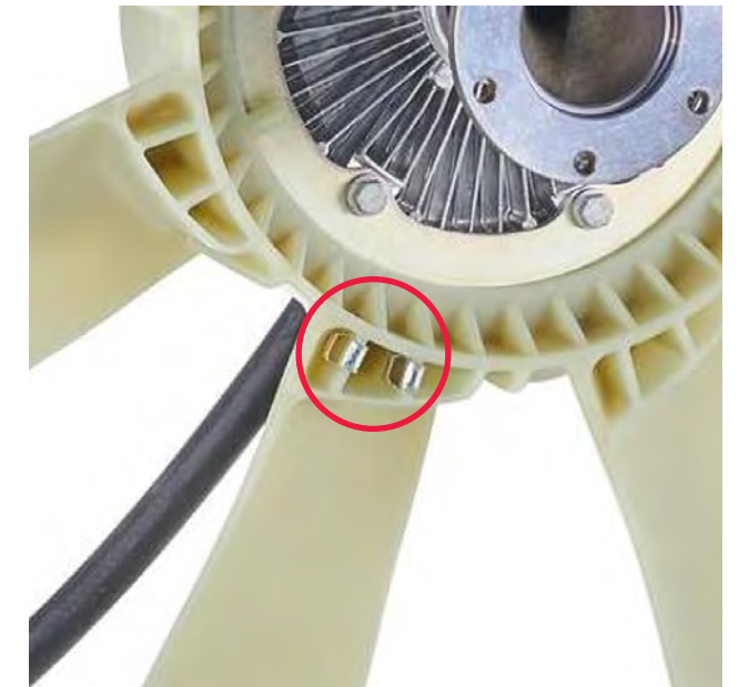
Resim 2 Balanslama için metal klips
