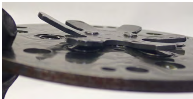
Resim 3 Sınırlama deforme olmuş
