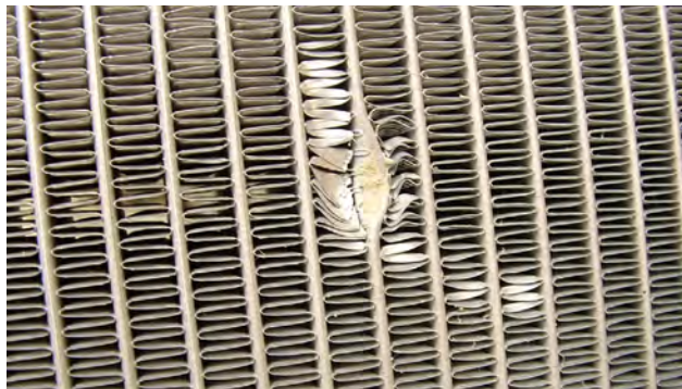
Resim 3 Radyatöre taş çarpması
