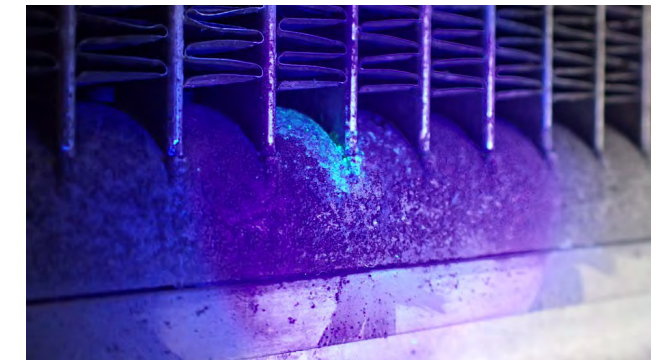
Resim 2 Kondansatörde paslanma
