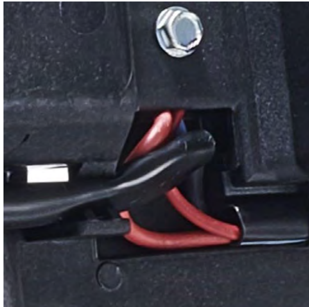
Resim 2 Fan kontrolünde kablo kopması
