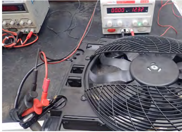
Resim 1 Fanın kontrol edilmesi
