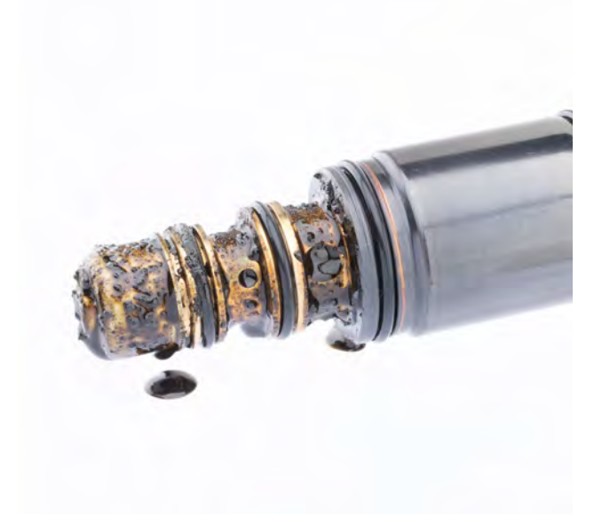
Resim 4 Manyetik valf üzerinde talaşlar ve siyah yağ
