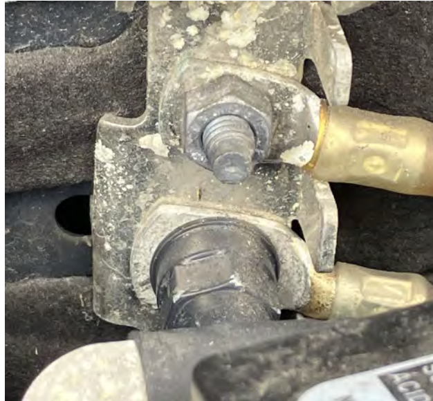
Resim 2 Topraklama noktasında korozyon
