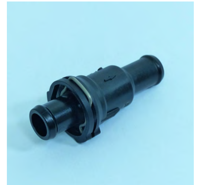
Resim 2 Şanzıman yağı eşanjörünün termostadı
