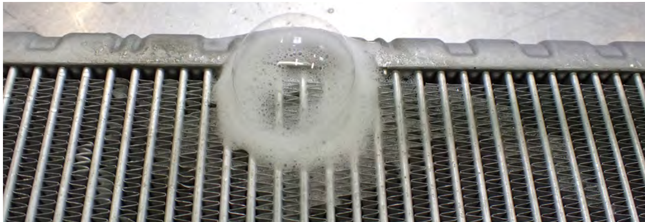
Resim 3 Evaporatör sızdırıyor
