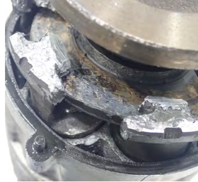
Resim 3 Piston ve eğik plakada sürtünme hasarı
