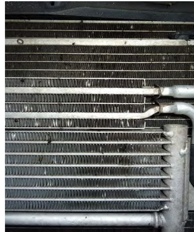
Resim 1 Radyatör üzerindeki kirlilikler
