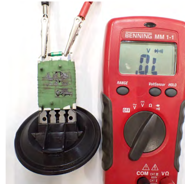
Resim 1 Yanmış regülatör testi
