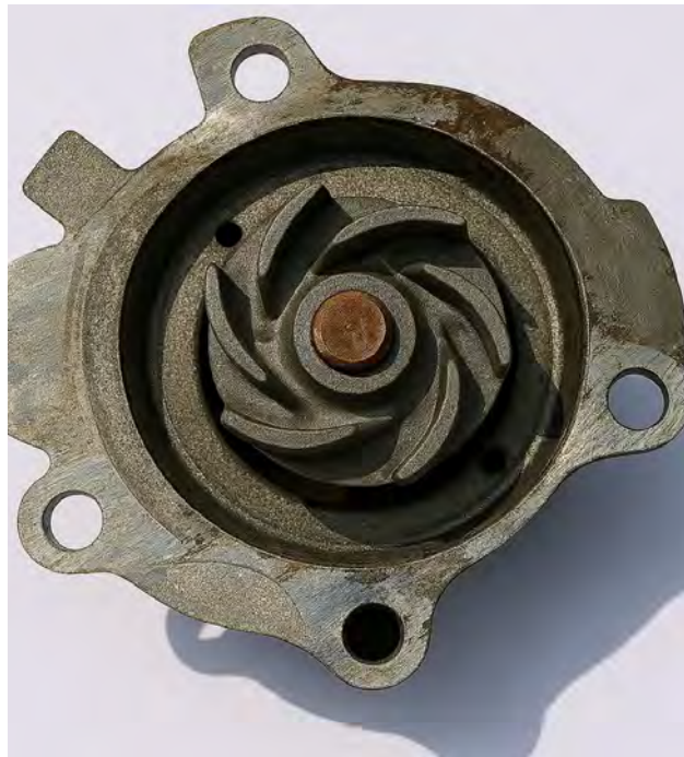
Resim 2 Metal kanatlı çark milden ayrılmış
