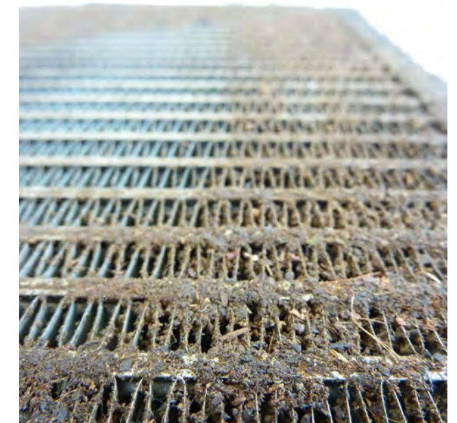
Resim 2 Tıkanmış evaporatör
