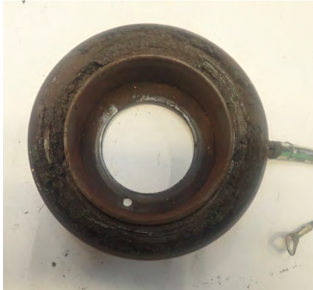
Resim 1 Kayan kavrama nedeniyle manyetik bobin erimiş
