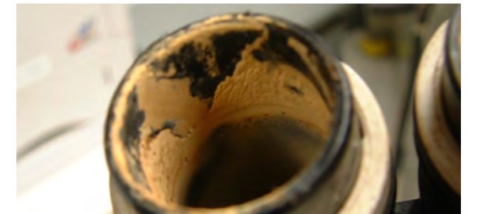
Resim 3 Soğutma sıvısı devresinde korozyon ve birikintiler
