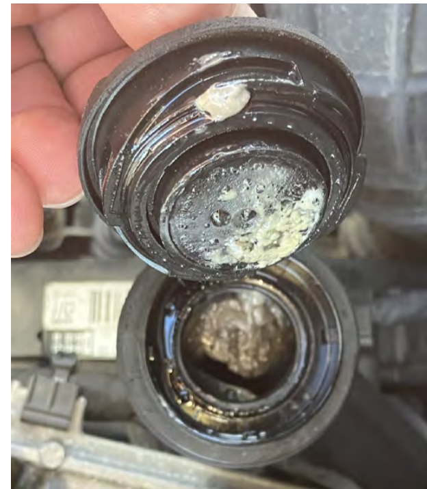
Resim 2 Yağ doldurma kapağı ve yağ doldurma ağzında yağ-su emülsiyonu
