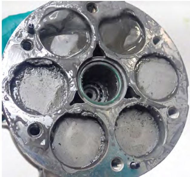
Resim 1 Piston ve silindirde aşırı sürtünme hasarı
