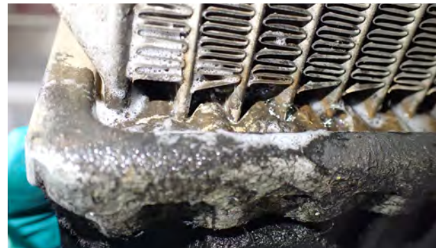
Resim 4 Radyatörün dış kısmında korozyon
