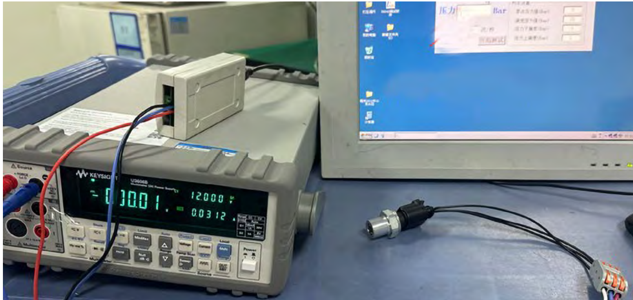
Resim 4 Bir basınç şalterinin laboratuvarında test edilmesi
