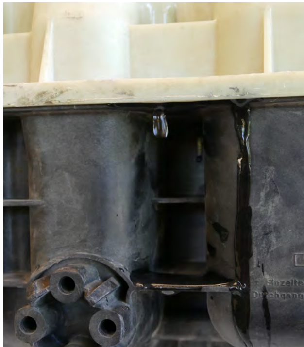
Resim 2 Genişleme haznesinden soğutma sıvısı damlıyor
