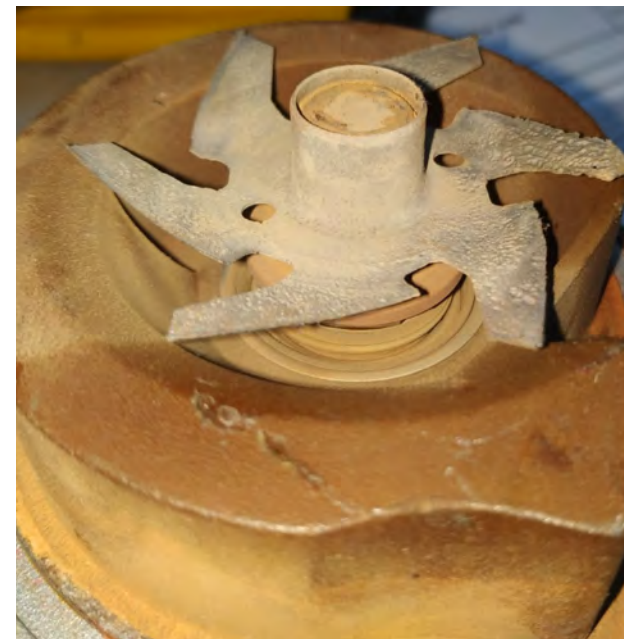
Resim 1 Soğutma sıvısı pompasında kavitasyon
