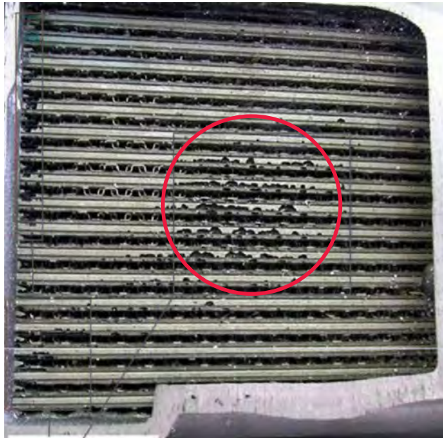
Resim 1 Yağ radyatörünün borularında kavitasyon
