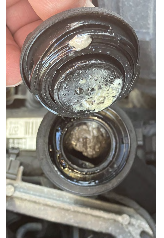
Resim 3 Yağ doldurma ağzında yağ-su emülsiyonu
