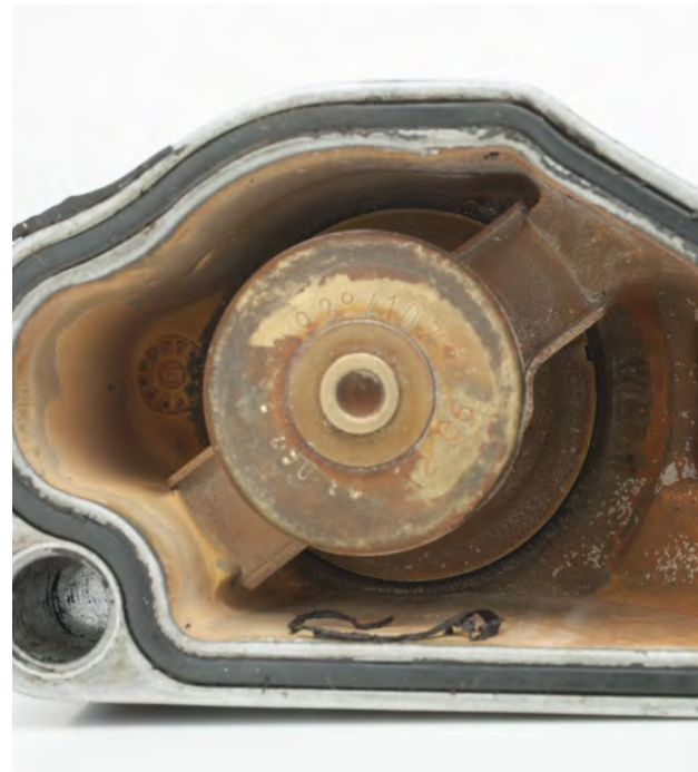
Resim 2 Termostatta korozyon
