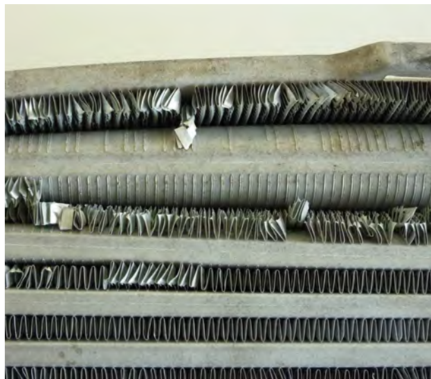
Resim 3 Radyatör borusu şişmiş
