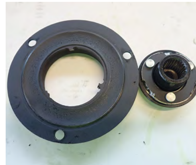
Resim 1 Aşırı yük emniyeti kırılmış
