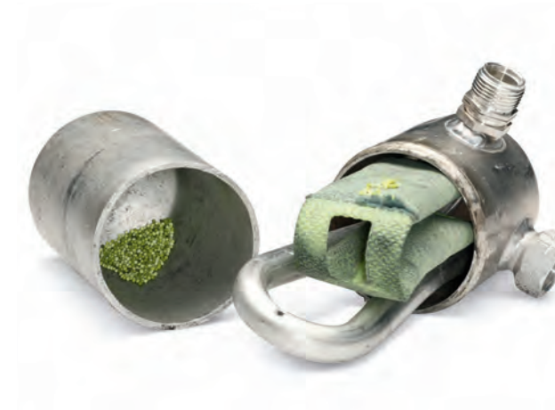
Resim 1 Filtre kurutucudan granül çıkması
