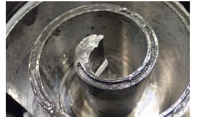
Resim 2 Salyangozda ön taraftaki conta tahrip olmuş
