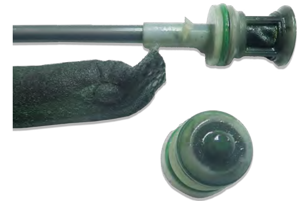
Resim 2 Filtre kurutucu tıkalı
