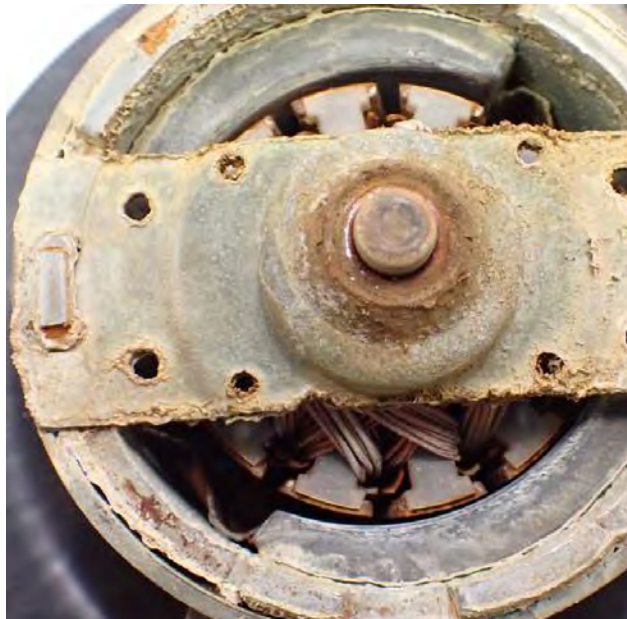
Resim 1 Fan motorunda yatak hasarı
