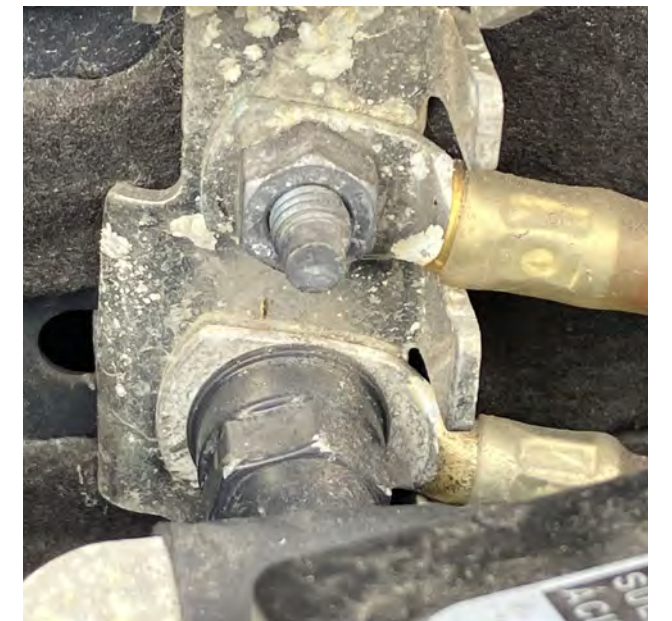
Resim 2 Topraklama noktasında korozyon
