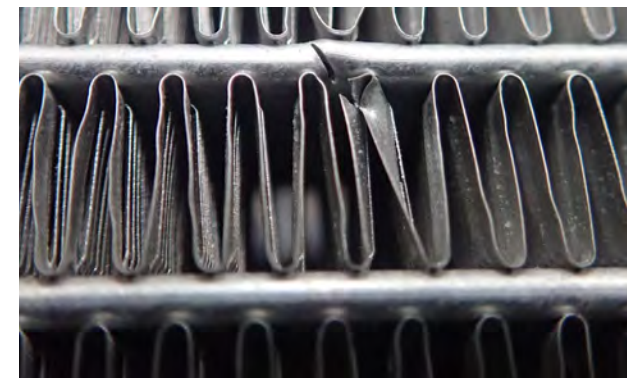
Resim 3 Mekanik hasar (kesik)
