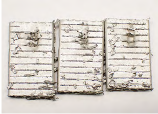
Resim 1 Boruların dıştan içe doğru deformasyonu
