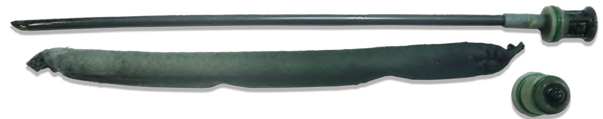
Resim 3 Filtre kurutucu tıkalı
