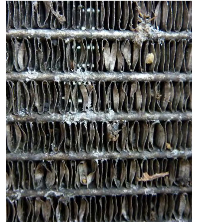
Resim 2 Kirlilikler ve deforme olmuş soğutma kanatçıkları
