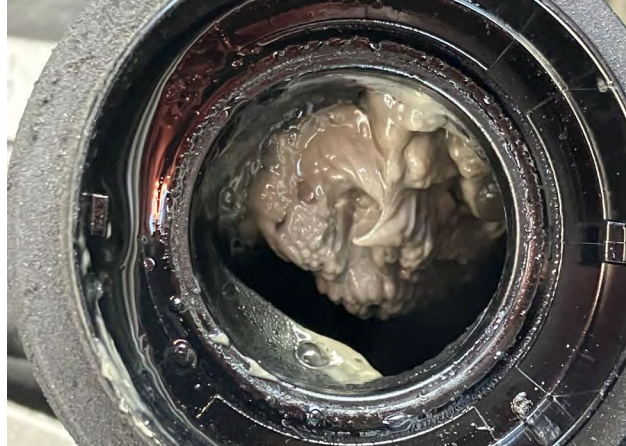
Resim 2 Yağ-su emülsiyonu
