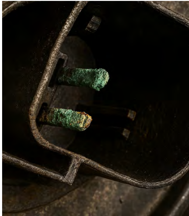
Resim 2 Soket bağlantısında korozyon
