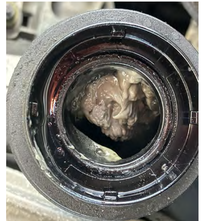
Resim 3 Yağ doldurma ağzında yağ-su emülsiyonu
