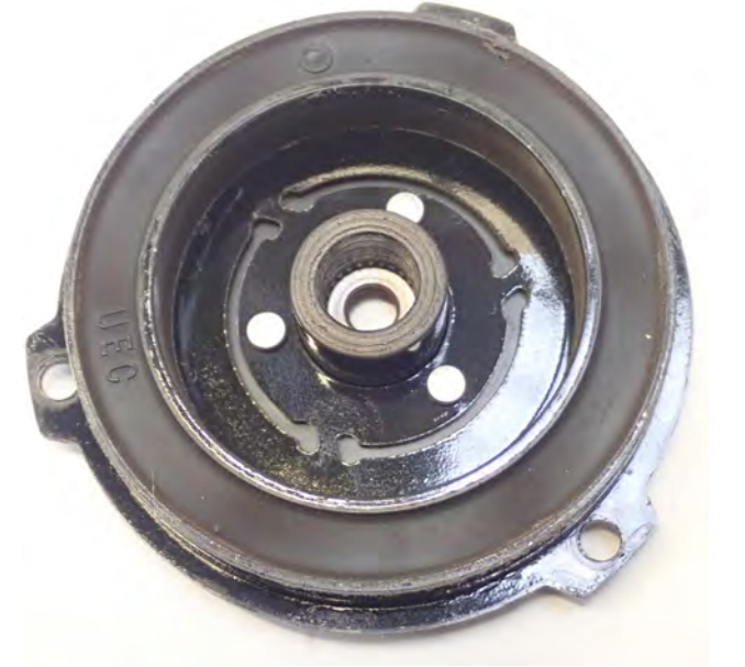
Resim 2 Göbekteki dişler kırılmış
