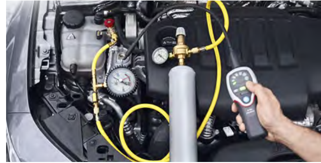
Resim 1 Şekillendirme gazı ile kaçak arama
