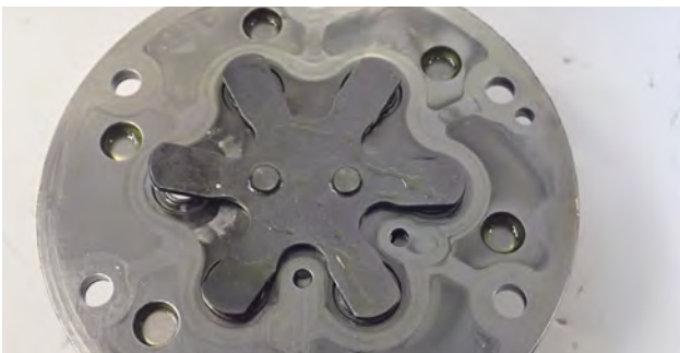
Resim 2 YB valfinin sınırlandırması deforme olmuş
